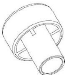
Zatyczka dozująca do montażu ponad głową oraz w poziomie Średnica wiertła (d 0 ): 24 mm do 40 mm
