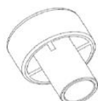
Zatyczka dozująca do montażu ponad głową oraz w poziomie VS Średnica wiertła ( d_0 ): 18 mm do 40 mm
